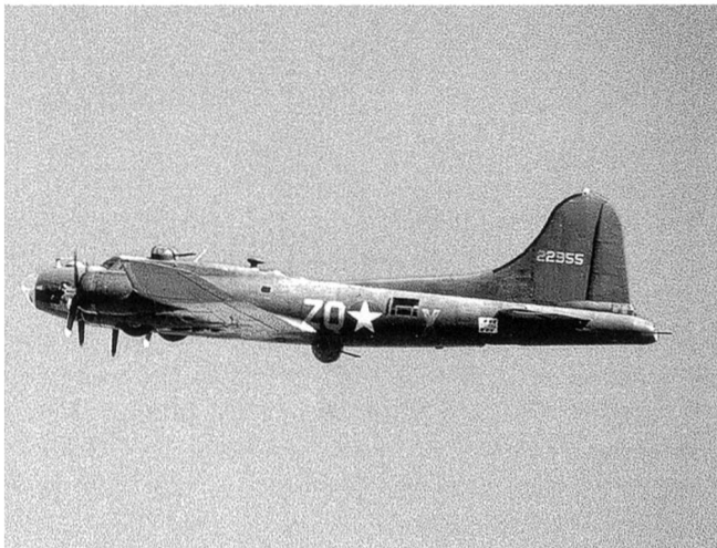
B-17G «Fliegende Festung»: gut erkennbar sind die MG-Stände an Bug, Heck, Rumpfober- und -unterseite.
