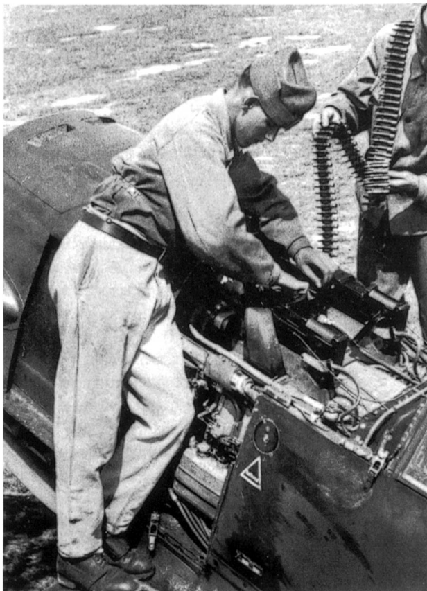
Die sorgfältige Wartung war die Grundvoraussetzung für einen störungsfreien Einsatz. Aufmunitionieren der durch den Propellerkreis schießenden Maschinengewehre.
