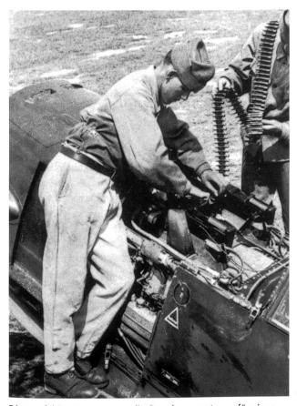
Die sorgfältige Wartung war die Grundvoraussetzung für einen störungsfreien Einsatz. Aufmunitionieren der durch den Propellerkreis schiessenden Maschinengewehre.
