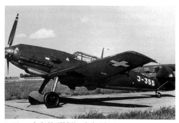
Der Messerschmitt-Me-109 E-Jäger, in der Schweiz genannt Me 109 DB. Deutlich erkennbar das schmale am Rumpf befestigte Fahrwerk. Bewaffnung: 2 MG, 2x20-mm-Oerlikon-Flügelkanonen. Geschwindigkeit 450 – 570 km/h.
