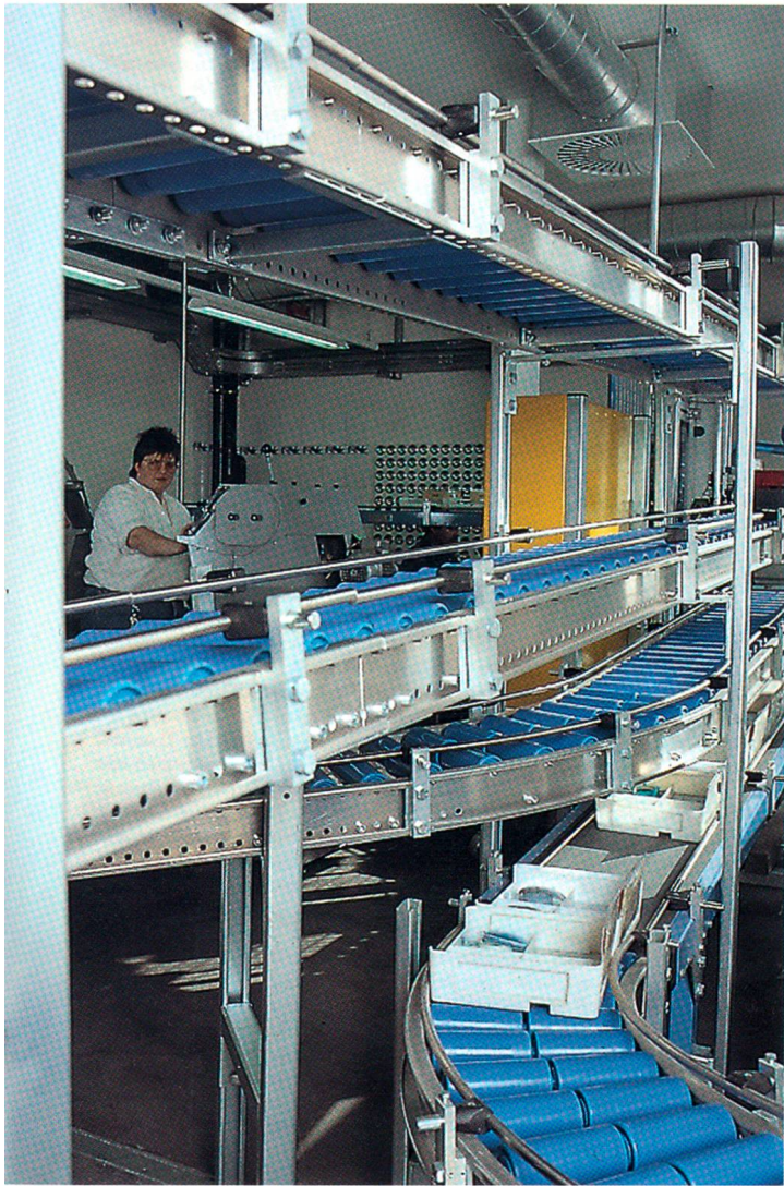
Schnelle, moderne Förderanlagen führen die Aufträge in logisch ausgeklügelter Abfolge von einem Produktionsschritt zum anderen
