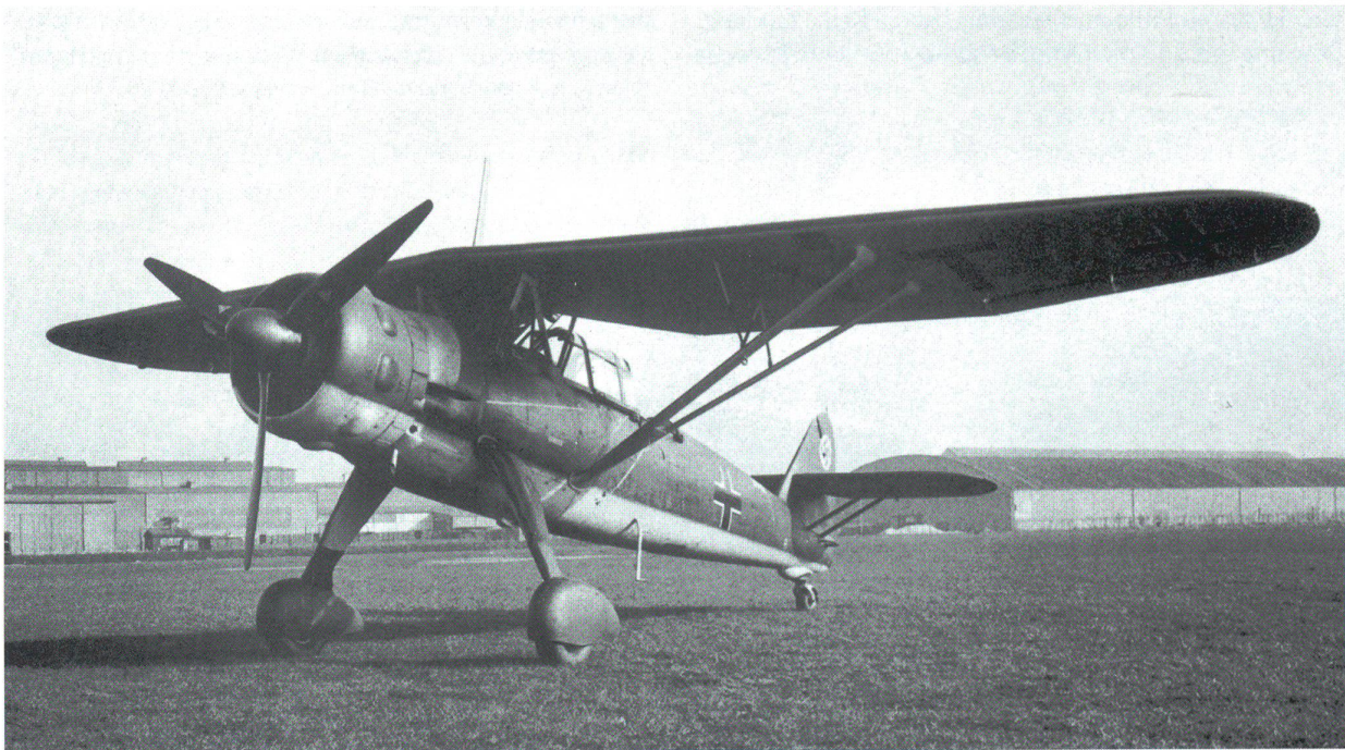
Das Spionageflugzeug, der Nahaufklärer Hs 126 B-1 der Henschel-Werke Stuttgart. Die Maschine war der erfolgreichste Nahaufklärer der deutschen Luftwaffe mit aussergewöhnlicher Vielseitigkeit durch Langsamflugeigenschaften. Baujahr: 1938, Länge: 10,85 m, Flügelspannweite: 14,5 m, Gewicht: 3,27 Tonnen, Höchstgeschwindigkeit: 355 km/h. 481 Flugzeuge wurden insgesamt produziert.
