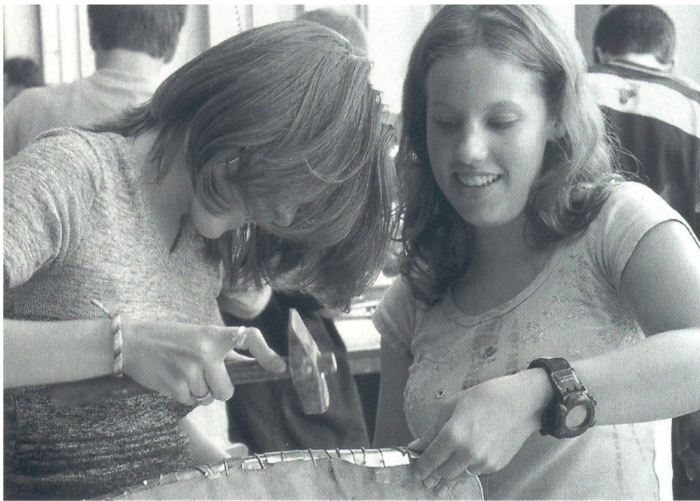
Das Messingblech wird über die Holzleiste gezogen.
