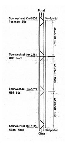
Schema der Spurwechselverbindungen im Hauenstein-Basistunnel (Zeichnung SBB)
