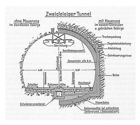
Normalquerschnitt eines zweigleisigen Tunnels (SBB Kr. II Verkehrstechnik 1941)
