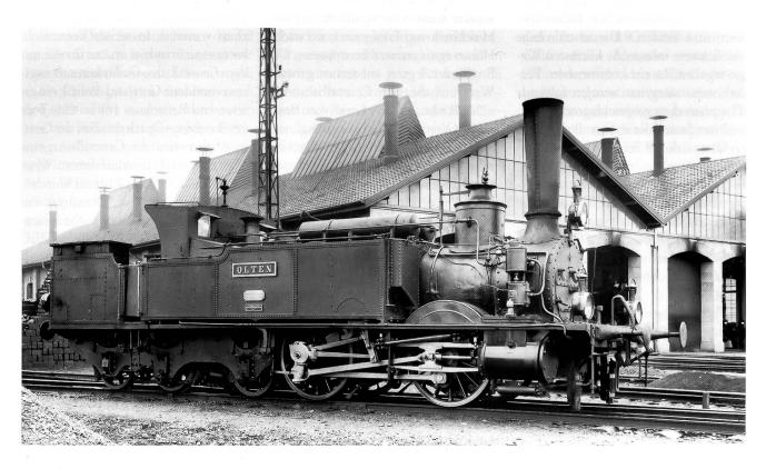
Engerth-Stütztender-Lokomotive B2E Nr. 4 der SCB nach den Umbauten mit Kamin für Kohlefeuerung, Führerstandsdach und Druckluftbremse, aufgenommen im Depot Basel um 1900
