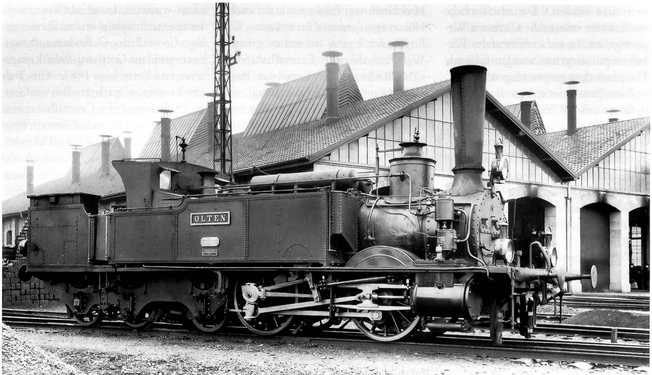
Engerth-Stützender-Lokomotive B2E Nr. 4 der SCB nach den Umbauten mit Kamin für Kohlefeuerung, Führerstandsdach und Druckluftbremse, aufgenommen im Depot Basel um 1900
