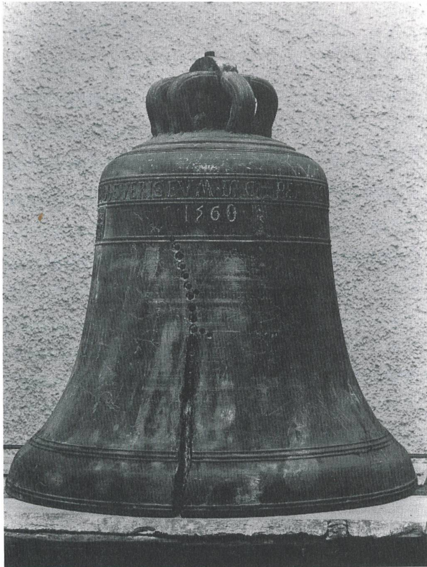
So sah die ehemalige Grosse Glocke von 1560 nach dem misslungenen Schweissversuch aus (Foto: Slg. StAO).
