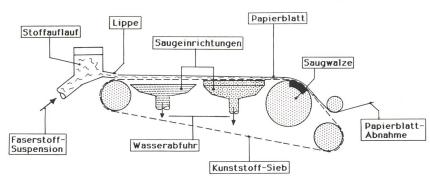
öffnungen des Transportbandes – es heisst Siebtuch – ab, während die Fasern darauf liegenbleiben und sich zum Papierblatt verfilzen. Das Sieb ist das eigentliche Herzstück einer Papiermaschine, ohne Sieb lässt sich kein «echtes Papier machen».
