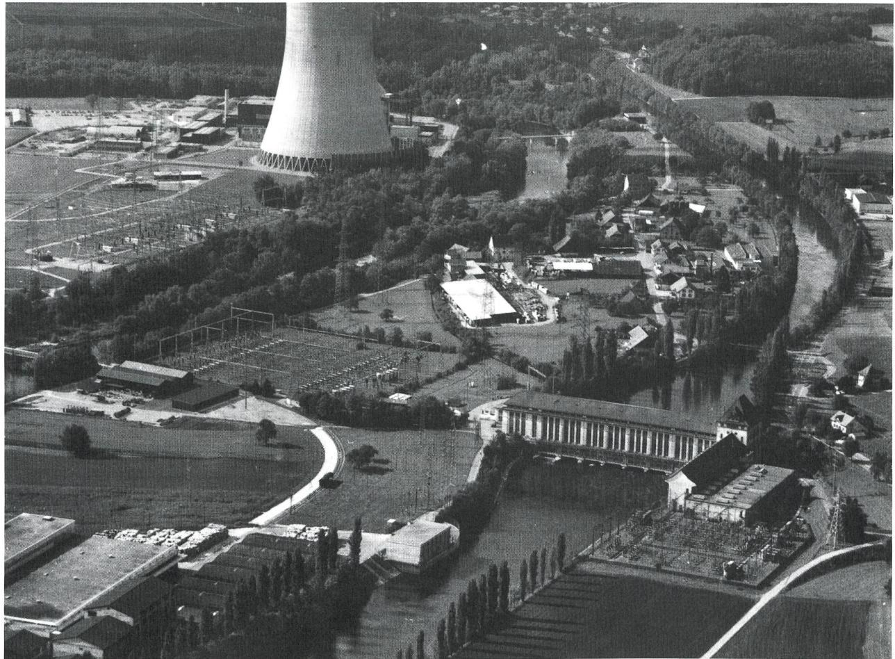
kV, 220 kV und 150 kV sind die Leitungen in jeder Spannungsebene über einzelne Sammelschienen miteinander verbunden. Die Spannungsebenen sind über Transformatoren zusammengekoppelt.
