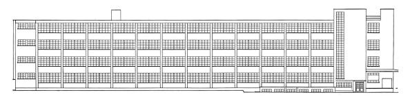
Robert Schild, *Schubfabrik Hug in Dulliken*, 1933 Westfassade, Projektplan mit ursprünglicher Fensterteilung. Skelettbauweise mit aussenliegenden Fassadenstützen. Grosse Flexibilität in der grundrisslichen Nutzung. Markante Ausbildung des Gebäudekopfes.
