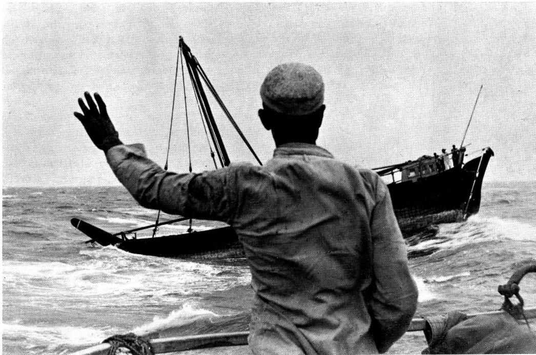
Abb. 1 Eine Boom während eines Sturmes in der Strasse von Hormuz. Gut erkennt man das Jochsteuer und das langgezogene Bugspriet.
