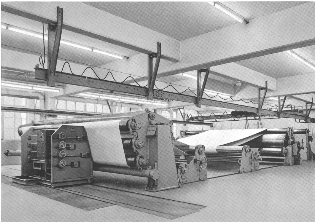
Eine Spann-, Rauh- und Trockenanlage
