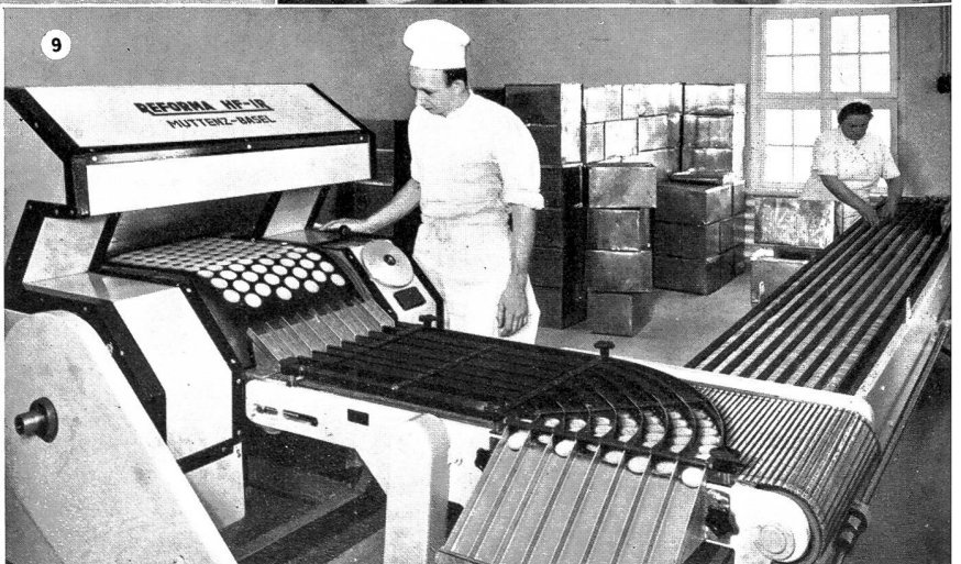
8/9 Der bahnbrechende Tunnelbackofen, Europas erste Anlage, welche Infra-rothitze mit Hochfrequenz-Durchstrahlung kombiniert. Bild oben zeigt, wie sich aus dem Teig die Biscuits formen, durch den Tunnel gleiten, um unten fertig gebacken in absoluter Gleichmässigkeit herauszukommen, bereit zur Verpackung.
