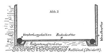
«Moosgräben», schematische Darstellung der Konstruktion der Wandläger
