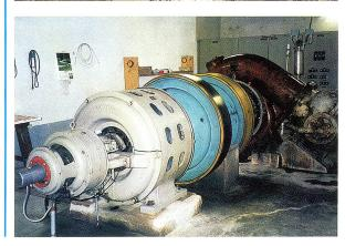
Maschinenanlage. Hinten Francis-Turbine, anschliessend Schwungräder und vorne der Generator.
