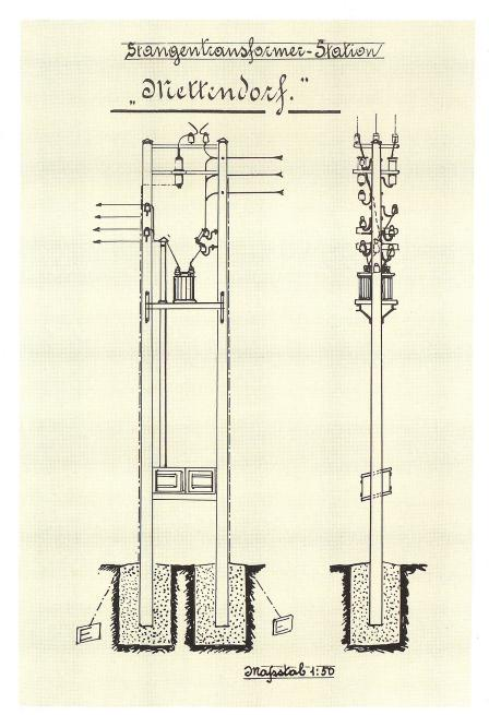
Für die Dorfkorporation entwarf Beat Steiner diese «Stangentransformer-Station». Konstrukteur, Zeichner und Aktuar in einer Person zu sein, war damals noch möglich!
