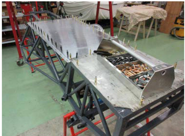
Nietarbeiten am Unterboden.
