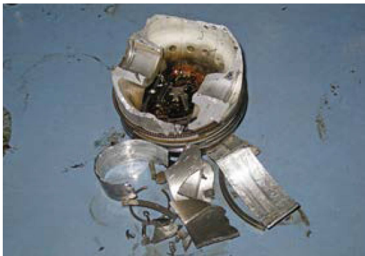
Ventil runter, Kolben hoch! Motor hinüber ... (Bild: zvg)
