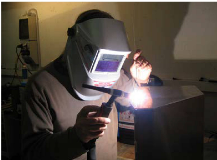
Roli Scholl korrigiert die Sicherheitsstruktur am Chassis.
