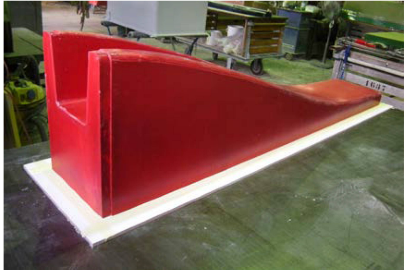
GFK-Formenbau für den Griffon Formel Renault Europe.
