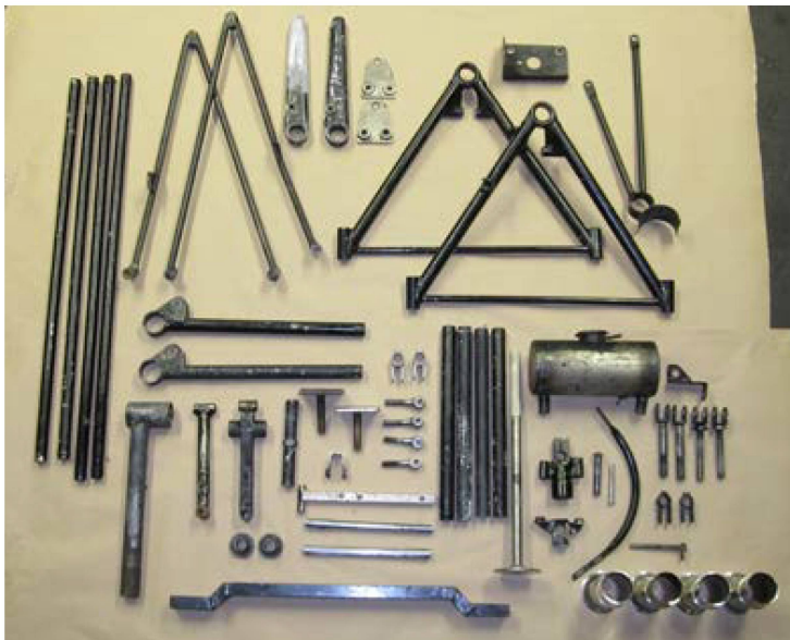
Teile nach der Restauration und vor dem Vernickeln. (Bilder: zvg)
