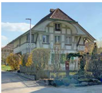
Stöckli Wyssenried von 1804. Mischkonstruktion mit massivem EG und OG in Rieg. Ründidach mit seltener Bogenform. Foto: Simon Kuert
