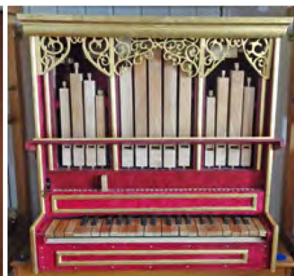
Zweite Ausführung, gebaut 2011–2013 Dieses Instrument hat den gleichen Tonumfang wie die erste Ausführung, jedoch versuchte ich, zwei Register mehr unterzubringen.
