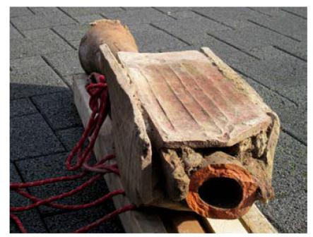
Bei der Rössli-Leitung gab es vorgefertigte Sollbruchstellen: Vor dem Eintritt in die Muffe ist das Rohr ringsherum 2 mm tief eingefeilt oder angesägt worden. Beachte die nicht ganz geschlossene Einkerbung vorne, und die Farbänderung links bei der eingesägten Kerbe. Ganz oben klebt Zement von der Abdichtung in der Muffe. Die Muffe hat einen leicht grösseren Innendurchmesser, so dass ein leichter Knick in der Linienführung möglich ist.
