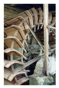
Abb. 6 Die gekrümmten Schaufeln des Wasserrades. Fotos Verfasser
