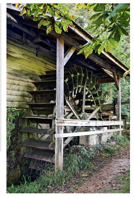
Abb. 8 Das Wasserrad des Ingenieurs Walter Zuppinger. Das Wasser fliesst von rechts gegen unten aufs Rad. Foto H. Rentsch
