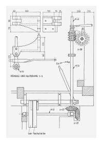
Abb.10 Kraftübertragung mittels Kegelzahnrädern (unten) und einer Schnecke (oben). Zeichnung B. Moog
