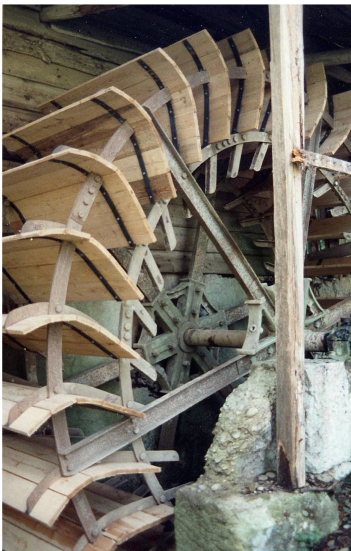
Abb. 6 Die gekrümmten Schaufeln des Wasserrades. Fotos Verfasser
