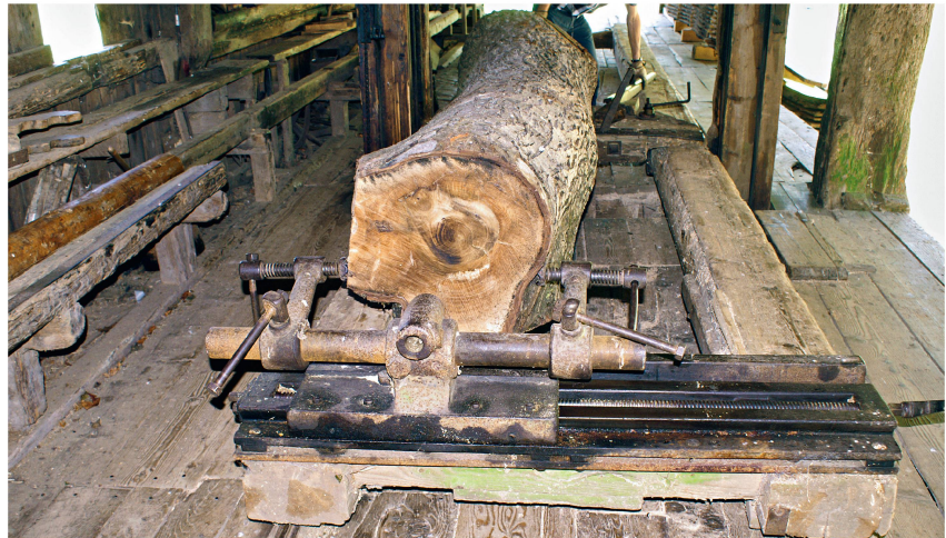
Abb. 9 Der Baumstamm liegt auf dem Wagen und ist fixiert. Foto Verfasser
