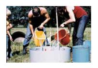
Abb. 2 Der Sickerversuch Oberönz (1975) ist ein Beispiel für die praxisbegleitende Umweltforschung. Bestimmung von Sickergeschwindigkeit, Sickerleistung und hydraulischer Durchlässigkeit mit der Doppelring-Infiltrometer-Methode, ergänzt durch Tensiometer.
