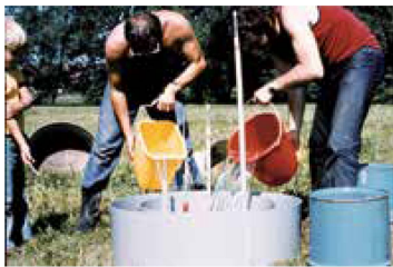
Abb. 2 Der Sickerversuch Oberönz (1975) ist ein Beispiel für die praxisbegleitende Umweltforschung. Bestimmung von Sickergeschwindigkeit, Sickerleistung und hydraulischer Durchlässigkeit mit der Doppelring-Infiltrometer-Methode, ergänzt durch Tensiometer.
