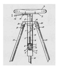
Der erste Girsberger-Drehstuhl mit stufenloser Höhenverstellbarkeit aus der Patentschrift von 1910
