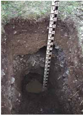
Abb. 3 Kolmatierung: Profil eines bewässerten Talbodens im obersten Inntal, Faggen. Unten die Schotter, darüber die über Bewässerung (und Hochwasser) aufgeschwemmte (kolmatierte) Feinerde. Foto Verfasser, 1977
