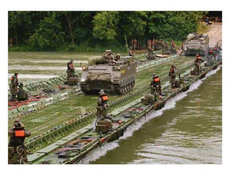
Schwimmbrücke 95 der Armee der Lastklasse 60 Tonnen. Foto Lehrverband Genie/Rettung, Zuchwil Bereits 1891 wurde der Pontonier-Fahrverein Aarwangen als erste Sektion im Oberaargau gegründet.<sup>4</sup>
