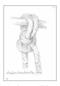
Ankertauknoten zum Anbinden schwerer Lasten (z. B. Anker)
