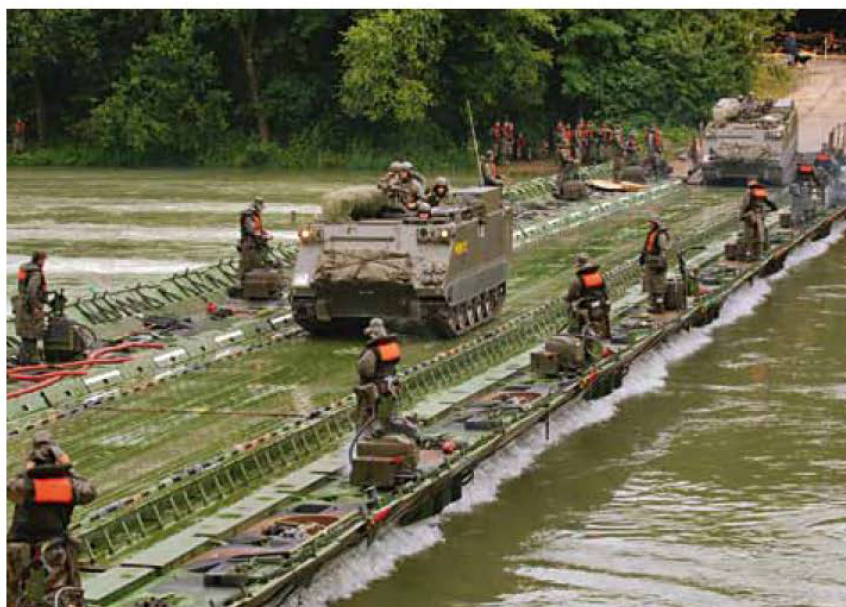
Schwimmbrücke 95 der Armee der Lastklasse 60 Tonnen. Foto Lehrverband Genie/Rettung, Zuchwil
