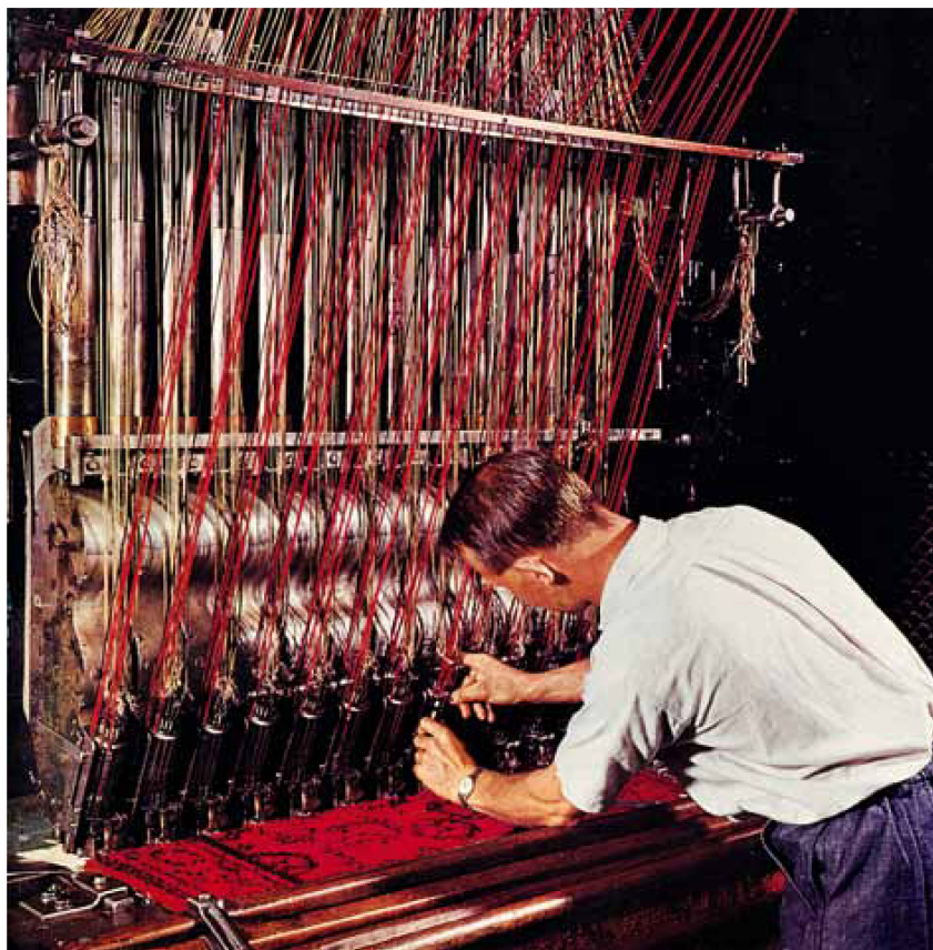
Teppichknüpfmaschine der Knüpft Teppichfabrik Lotzwil. Foto aus der Ciba Rundschau 1961/4. Privatbesitz
