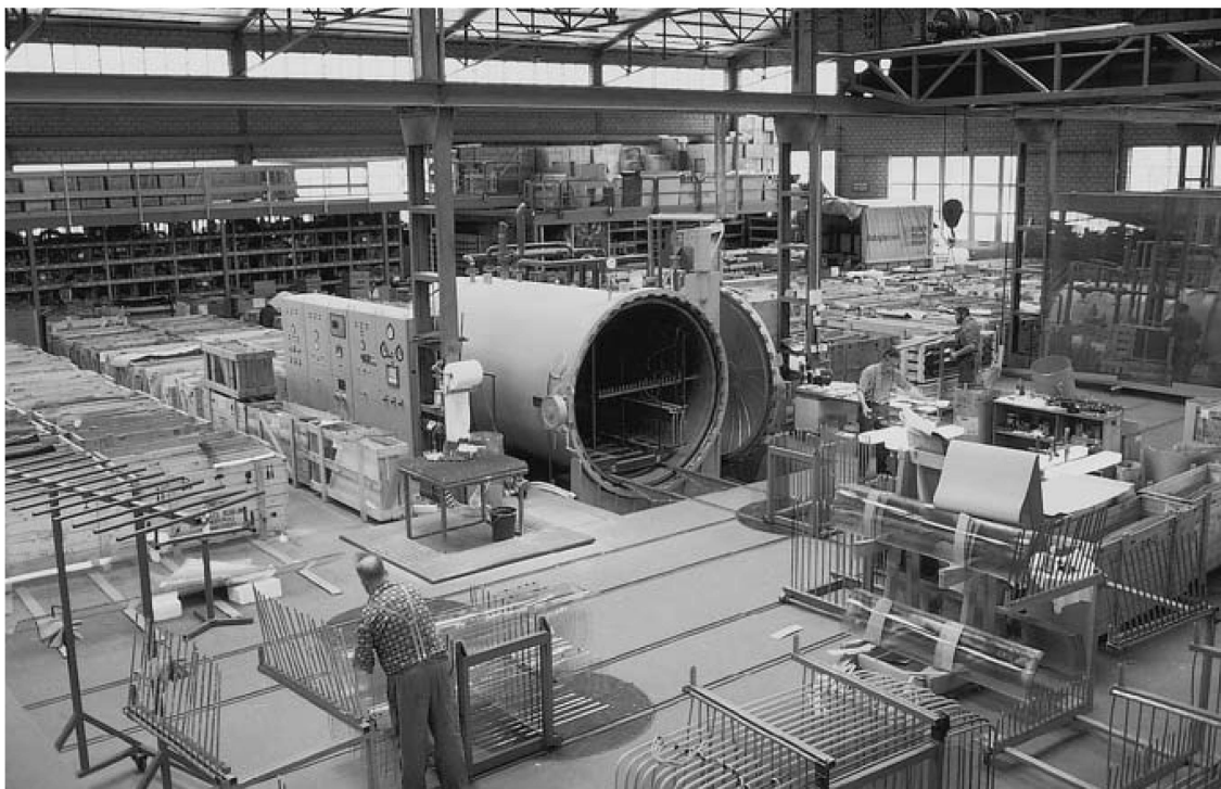
Produktion von Windschutzscheiben aus Verbundsicherheitsglas in Ursenbach
