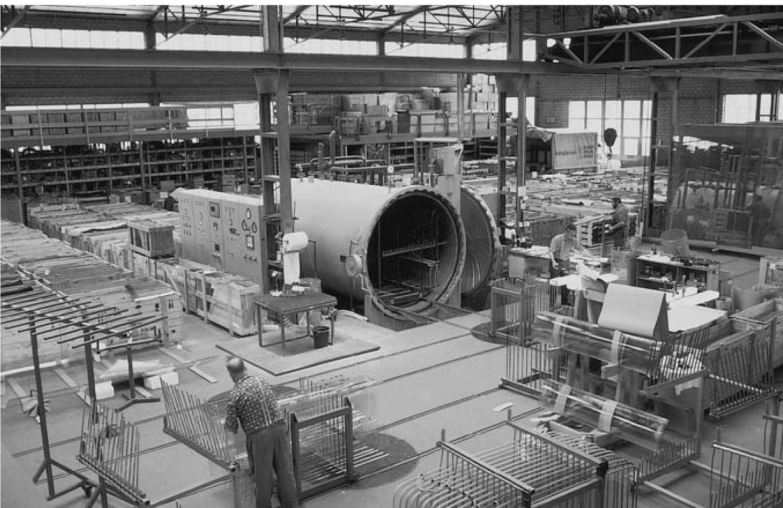
Produktion von Windschutzscheiben aus Verbundsicherheitsglas in Ursenbach
