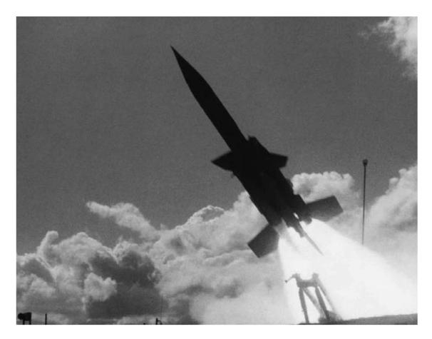
Lenkwaffenabschuss in England. Im Feuerstrahl sichtbar die Abschussrampe. Die Lenkwaffe mit den Startraketen samt Stabilisatoren, die später abgeworfen werden. Weiter vorne die Steuerflügel, die die Lenkwaffe ins Ziel steuern.
