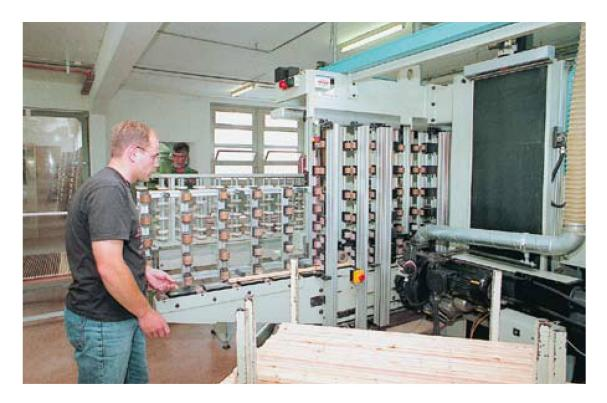
Mit modernsten CNC-Maschinen werden heute die Teile der Lattenroste hergestellt.
