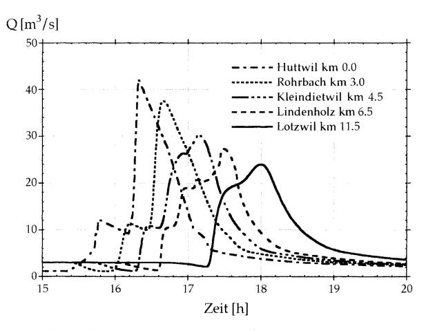
Abb. 9: Verformung der Hochwasserwelle vom 16. Juni 1988 zwischen Huttwil und Lotzwil (simuliert).
