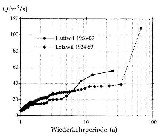
Abb. 3: Frequenzdiagramm der Jahresmaxima des Abflusses in den Pegeln Huttwil (Einzugsgebiet 60 km²) und Lotzwil (115 km²).
