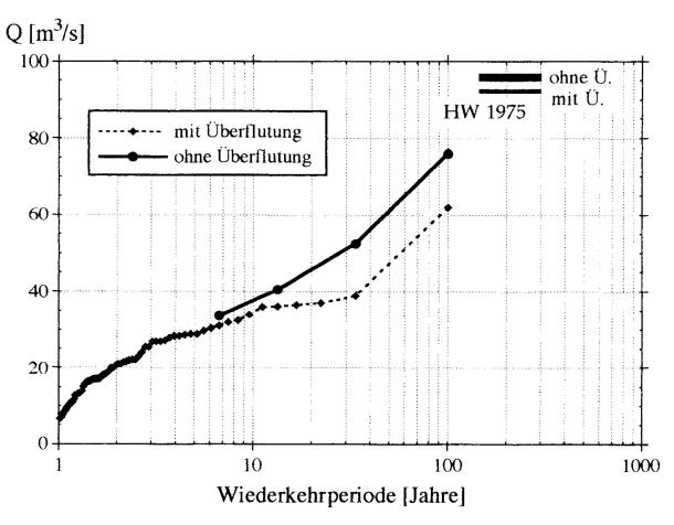
Abb. 14: Frequenzdiagramm der Scheitelabflüsse im Pegel Langete/Lotzwil mit Vorlandüberflutungen (beobachtet) und ohne Vorlandüberflutungen (simuliert).
