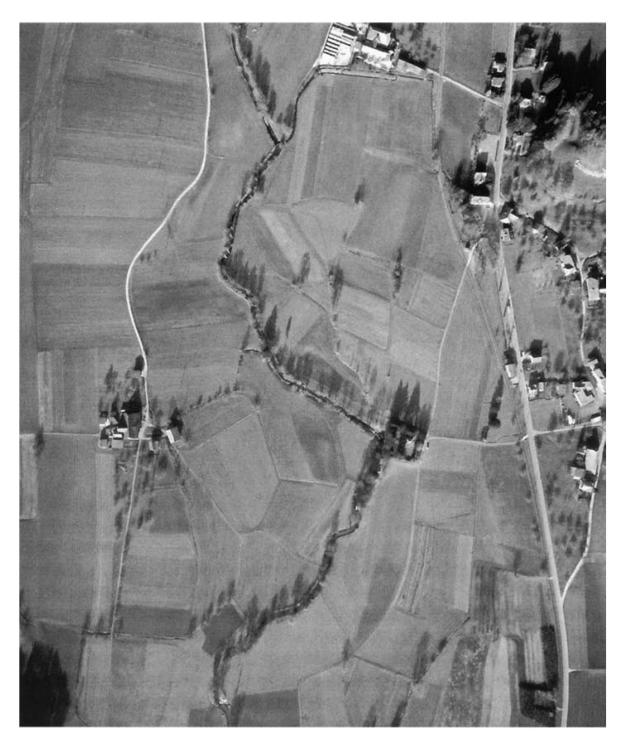
*Abb. 8:* Luftbild des Sohlentales südlich von Lotzwil: Die Langete fliesst von Süden (unten) nach Norden und ist durch die baumbestandenen Ufer erkennbar. Im rechtsufrigen Vorland begrenzen ein Fahrweg (Bildmitte) und der hochliegende Mühlenkanal (oberer Bildrand) jeweils einen grossflächigen Retentionsraum (Befliegung 4. Dezember 1978, Geographisches Institut der Universität Bern).
