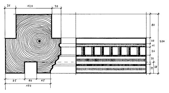
Abb. 13. Deckenbalken im Nordost-Zimmer. Er wurde mit dem gleichen Profilhobel verziert wie die Brust- und Sturzriegel aussen. Auch die mit dem Stechbeitel gestemmten Kerben (Abb. 11) kehren wieder. Massaufnahme nach einem Bruchstück, Zeichnung W. Gfeller
