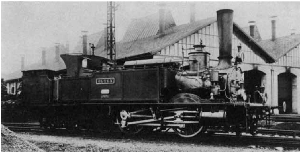
Vierte Lokomotive der Schweizerischen Centralbahn: S-C-B Nr. 4 «Olten». Tender-Lok 2/5 gekuppelt (2 Trieb- und 3 Laufachsen). System Ingerth, Lokomotiv-Fabrik Esslingen. Baujahr 1894. Später Nr. 6998 der SBB, ausrangiert 1905. Aus A. Moser: Der Dampfbetrieb der schweizerischen Eisenbahnen 1847–1966.
