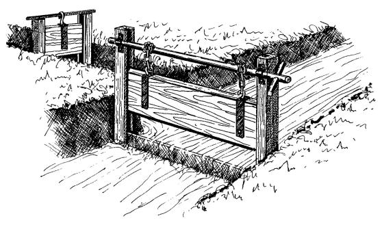
Schwelle und Pritsche, wie sie die Gebrüder Hofer um 1770 errichteten. Später wurden solche Schwellen in Mauerwerk und Metall erbaut.
