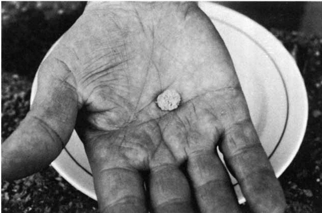
Abb. 13: Reines, ausgeglühtes Gold, mit dem Amalgamverfahren gewonnen.
