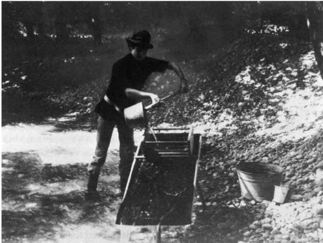
Abb. 11: Auf Goldsuche in der Langete, zwischen Langenthal und Roggwil. Technik der Goldwäscherei mit Wasch-Stuhl (Rekonstruktion nach Museumsobjekt durch den Verfasser). Der mit goldhaltigem Kies gefüllte Siebkorb wird mit Wasser übergossen. Die Schwermine- ralien samt dem Gold bleiben in den Fasern des Tuches hängen und dieses wird schliesslich im Zuber ausgewaschen. Foto Val. Binggeli, Langenthal 1981.
