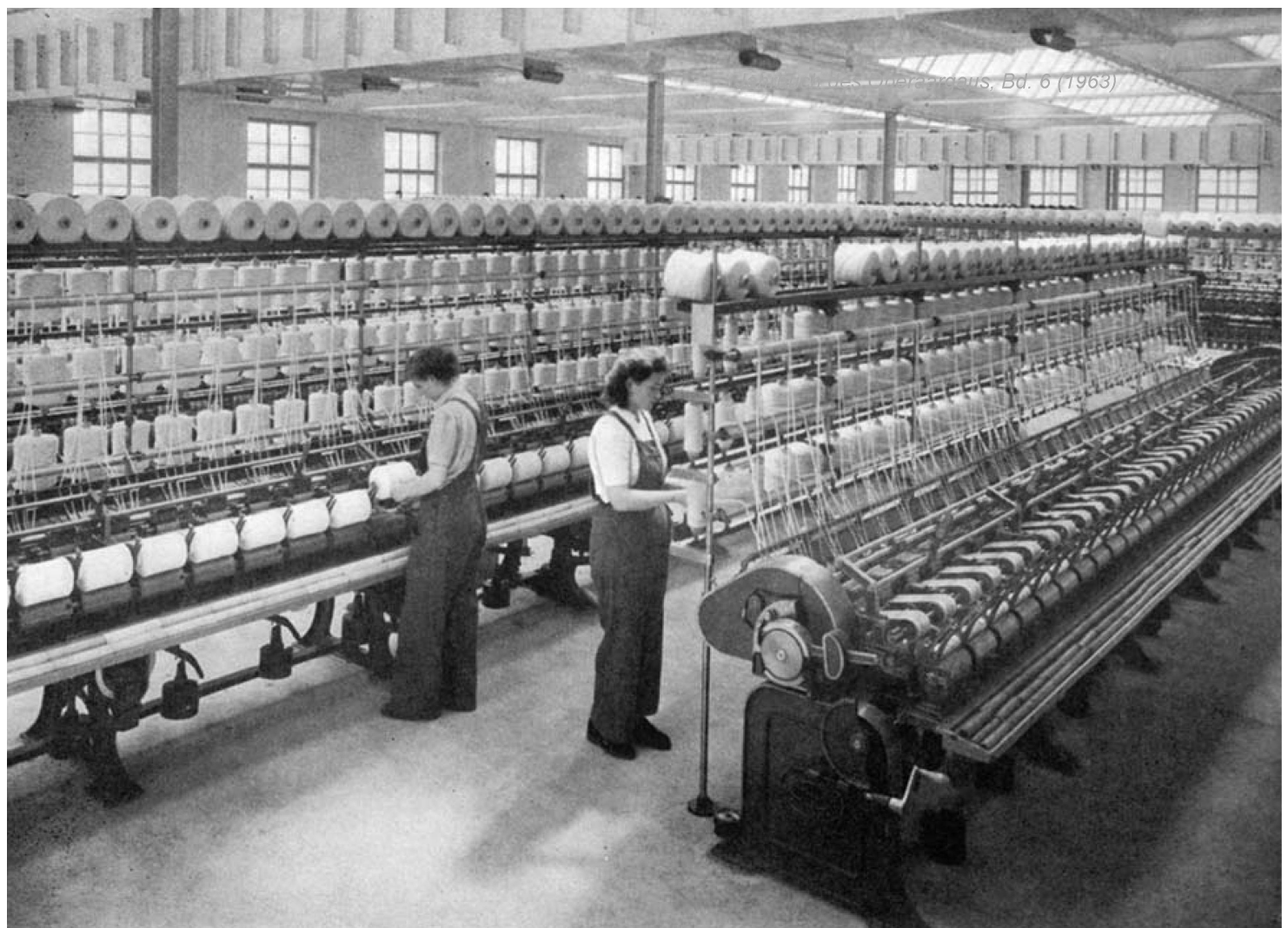
Kammgarnspinnerei Langenthal. Oben: Vorbereitung, letzte Passage. Unten: Ringspinnmaschinen
