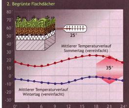
Abb. 23: Vergleich der mittleren Tagestemperaturen im Sommer und Winter bei einem unbegrünten (links) und einem begrünten Dach (rechts). Je nach Standort des Gebäudes und Qualität der Dachbegrünung können beim unbegrünten Dach jährliche Temperaturunterschiede von 100 °C auftreten, während diese beim begrünten Dach um 35 °C betragen. Durch die Dachbegrünung wird der städtische Wärmeinseleffekt reduziert. (Quelle: https://www.schwarz-landschaftsbau.de/dachbegruenung/vorteile.htm)
