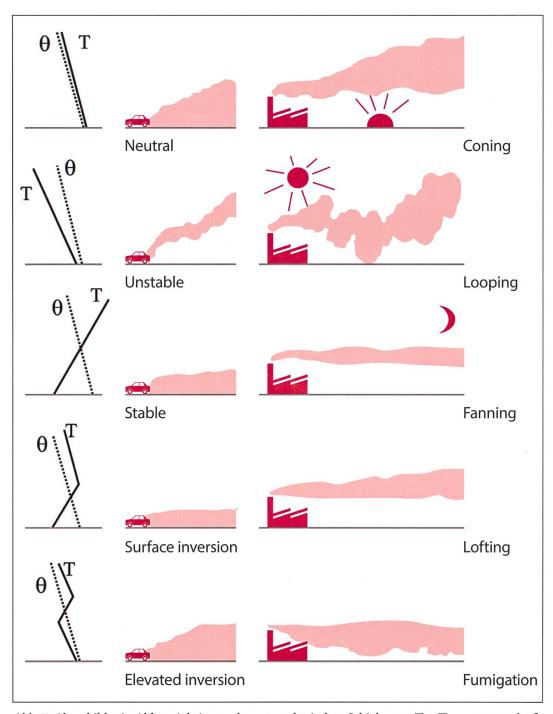
Abb. 7: Abgasbilder in Abhängigkeit von der atmosphärischen Schichtung. T = Temperaturverlauf der Umgebung,  $\theta$  = Adiabatischer Temperaturgradient.
