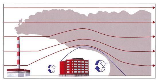
Abb. 9: Luftwirbel auf der Hinterseite des Gebäudes können zu einem Downwash-Effekt und daher zu einer erhöhten Verschmutzung führen. Lösung: Es ist ein ausreichender Abstand zwischen Emittent und Gebäude einzuplanen oder der Kamin ist zu erhöhen.
