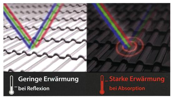
Abb. 20: Die Gebäudeerwärmung ist geringer, wenn die solare Einstrahlung durch helle Farben teilweise reflektiert wird, während dunkle Farben die Strahlung vermehrt absorbieren und dadurch zu einer starken Erwärmung beitragen. Bei zunehmend heisseren Sommern als Folge des Klimawandels muss die Farbgebung zukünftig vermehrt beachtet und optimiert werden. (Quelle: https://www.baulinks.de/webplugin/2012/1219.php4)
