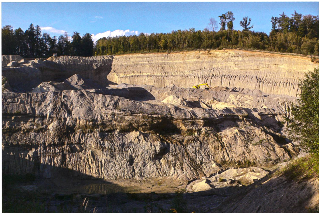
Abb. 90: Eiszeitliche Schotter werden an verschiedenen Stellen im Kanton Schaffhausen abgebaut. Eine solche Abbaustelle befindet sich am Solenberg. Sie erschliesst zwei durch eine Moränenschicht getrennte Schottervorkommen. Oben: Schematischer Querschnitt, unten: Ansicht der Grubenwand im Schotterkörper.
