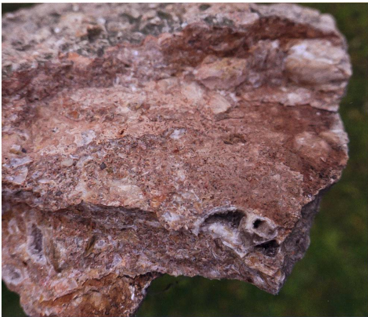
Abb. 68: Randengrobkalk — in gewissen Phasen ein beliebter Baustein in Schaffhausen und Umgebung. Bildbreite ca. 10 cm.
