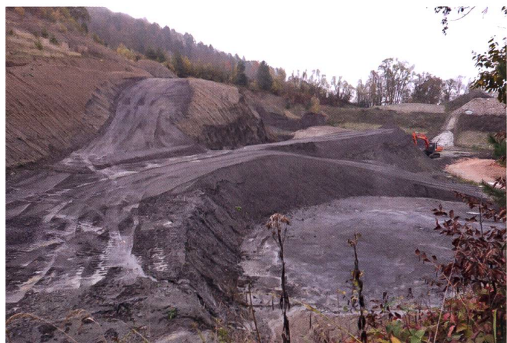
Abb. 48: Tongrube Birchbühl; Abbaustelle im Opalinuston, ein Rohstoff für die Ziegeleiindustrie. Die Grube wird wieder aufgefüllt mit sogenanntem «Inertstoff», also mehrheitlich Bauschutt, der nicht anders verwertet werden kann.
