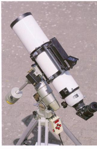
Das private Teleskop des Autors, ein 115 mm-Refraktor mit 805 mm Brennweite. Es verfügt über eine parallaktische Montierung und eine GoTo-Steuerung BILD: KLAUS MESTEL
