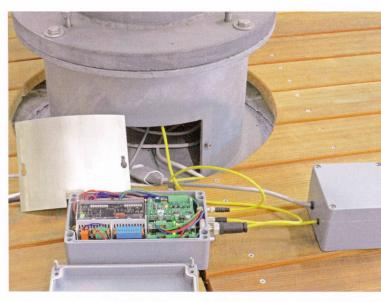
Einbau in den Sockel des Newton-Teleskops: Steuercomputer mit Verstärkerelektronik
