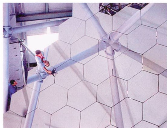
Ein segmentierter Spiegel wird zusammengesetzt
