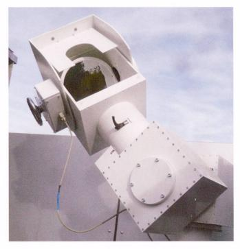
Links: Der Heliostat wird mit einem Pneukran zum Einbau auf das Dach des Planetariums «geflogen». Rechts: Die mechanische Komponente des Heliostaten auf dem Dach des Planetariums fängt mit dem nachgeführten Spiegel das Bild der Sonne ein Bilder: Marcel Vetter, Bruno Eberli
