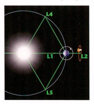
Die Erde auf der Umlaufbahn um die Sonne und der die Erde begleitende Punkt L2. Das JWST wird nicht genau im Punkt L2 platziert, sondern leicht seitlich davon. Zusätzlich zu seiner Bahn um die Sonne kreist das JWST also auch um den Punkt L2, womit eine optimale Infrarot-Schutzwirkung erzielt wird
