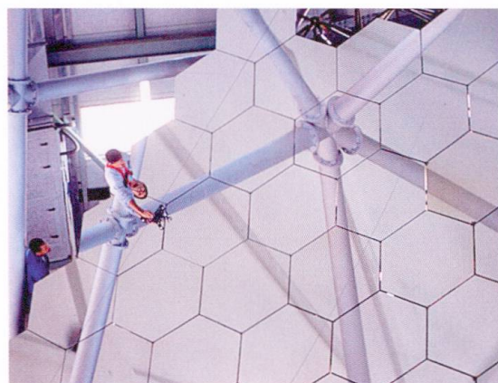
Ein segmentierter Spiegel wird zusammengesetzt
