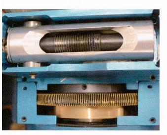
Das Schneckengetriebe, mit dem das Newton-Teleskop bewegt wird
