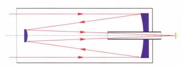
Der Strahlengang eines Cassegrain-Teleskops
