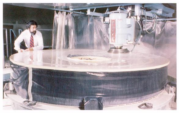
Der Spiegel des Weltraumteleskops Hubble wird geschliffen (1979). Er hat einen Durchmesser von 2.4 Metern
