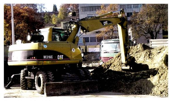
Baumaschine mit Partikelfilter vor dem Auspuff.
