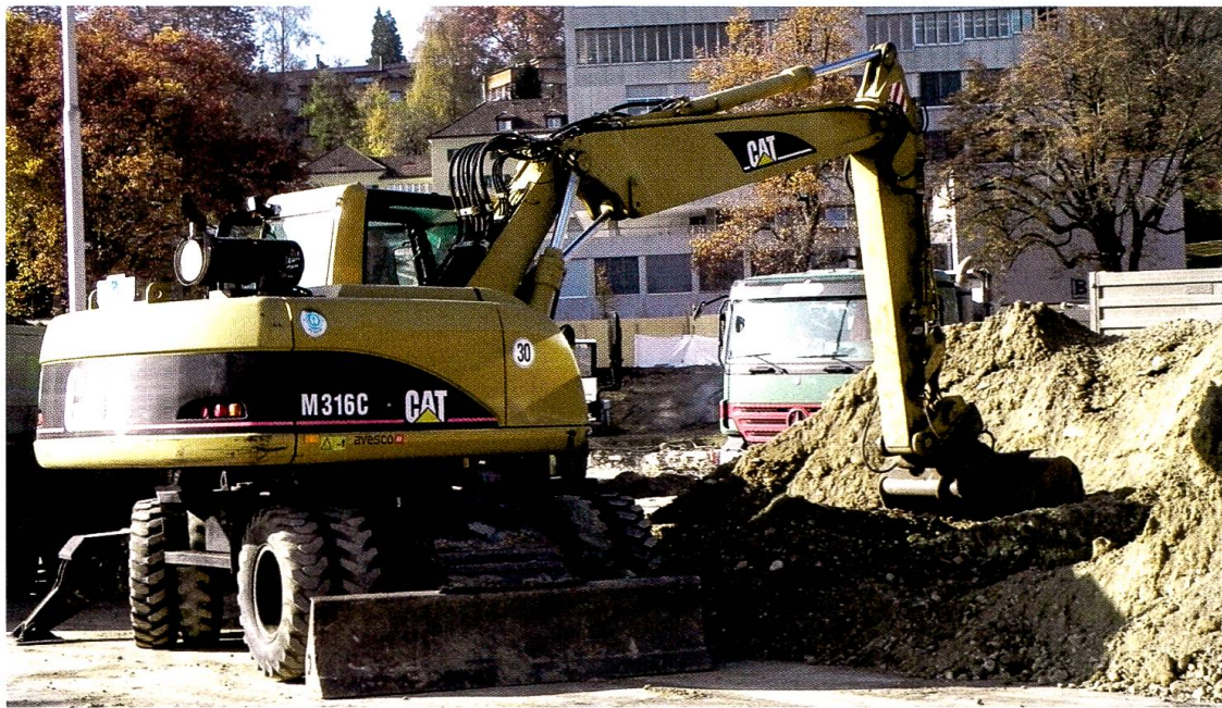
Baumaschine mit Partikelfilter vor dem Auspuff.
