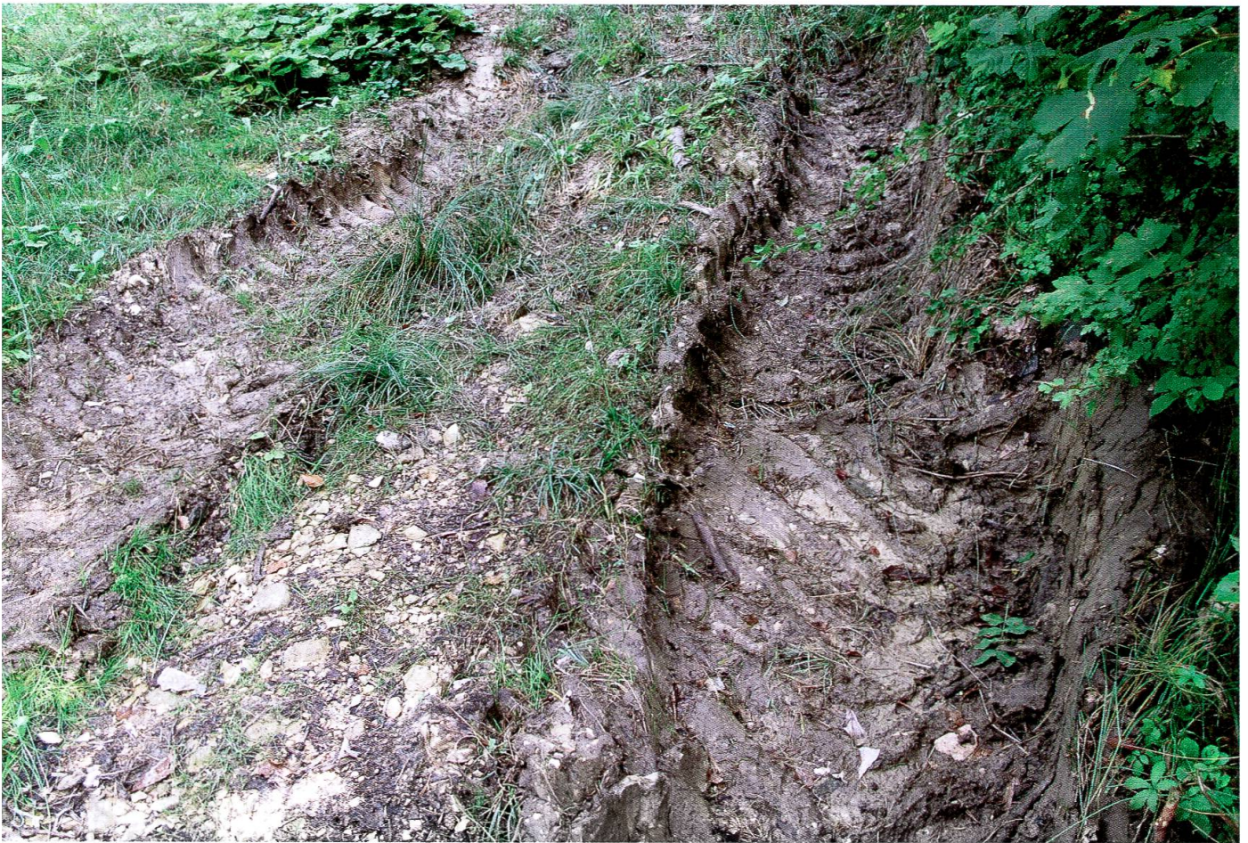
67 Die Tragfähigkeit der Böden nimmt mit zunehmendem Wassergehalt ab. Wenn ein tonreicher Boden bei nassen Verhältnissen zu stark belastet wird, wird er nachhaltig geschädigt.
