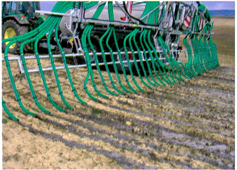
106 Gülleausbringung mit einem Schleppschlauchverteiler. Foto: Vakutec, Österreich
