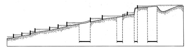
Abb. 4: Längsschnitt durch den Hochrhein zwischen Konstanz und Basel, überhöht. Die vier ungestauten Abschnitte sind mit schwarzen Balken markiert (Quelle: Bundesamt für Wasserwirtschaft, Stand 1980).
