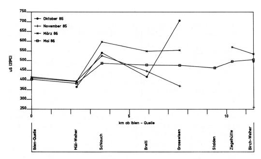
Abb. 17: Verlauf der elektrischen Leitfähigkeit des Durachwassers an vier Messterminen 1985 und 1986
